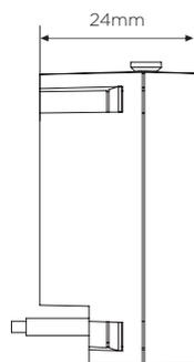
Figura 4. Dimensões - Vista Lateral
