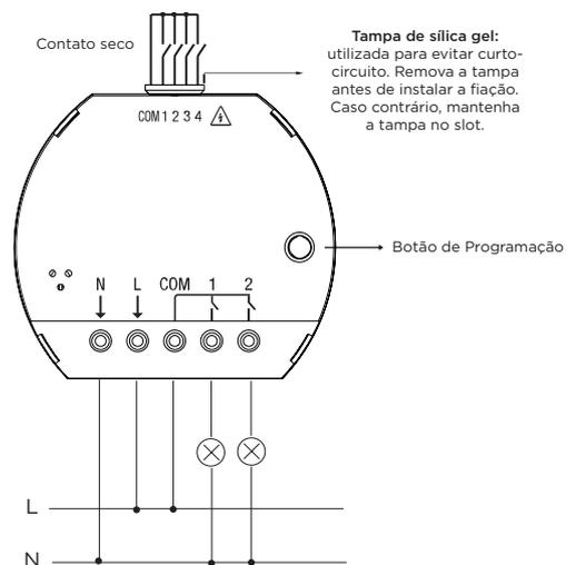
Figura 5. Ligação Elétrica - Exemplo
